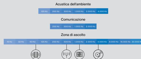
Le frequenze rilevanti per la comunicazione vanno da circa 200 Hz a 2.000 Hz. Nell'acustica degli ambienti interni, in genere si considerano le frequenze da 125 Hz a 4.000 Hz per creare condizioni sonore ottimali. Le alte frequenze sono percepite in modo particolarmente intenso dall'orecchio umano, la maggior sensibilità del sistema uditivo è compresa tra 2.000 Hz e 4.000 Hz.
